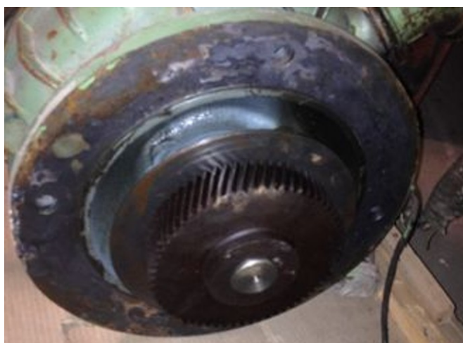
Pilt 3. Mootorreduktori esimene hammasratas võib paikneda mootori völlil.
